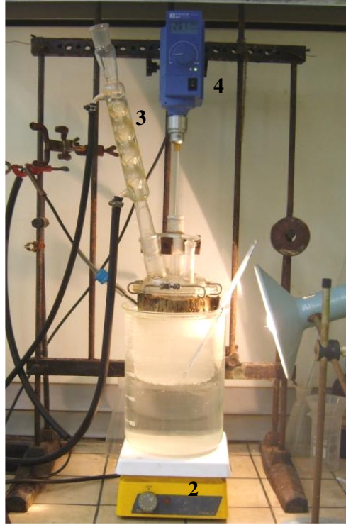
Şekil 4.4 Polimerizasyon deney düzeneği (Duranoğlu Gülbayır, 2008) (1.Reaktör, 2.İsıtıcı, 3.Geri soğutucu,4.Mekanik karıştırıcı)
