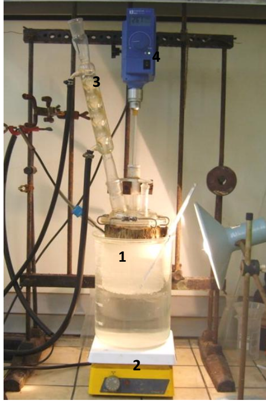
Şekil 4.1 Polimerizasyon deney düzeneği (1.reaktör, 2.ısıtıcı, 3.geri soğutucu, 4.mekanik karıştırıcı)
