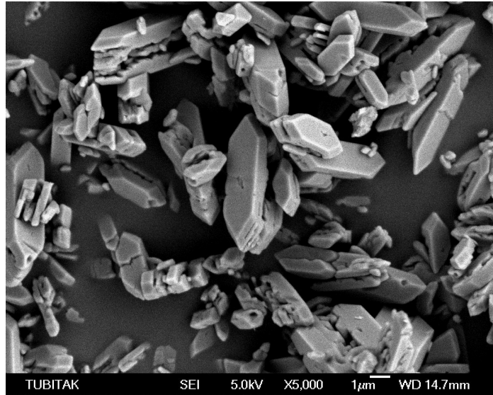
Şekil 10.2 COM aşı kristaline ait SEM görüntüsü
