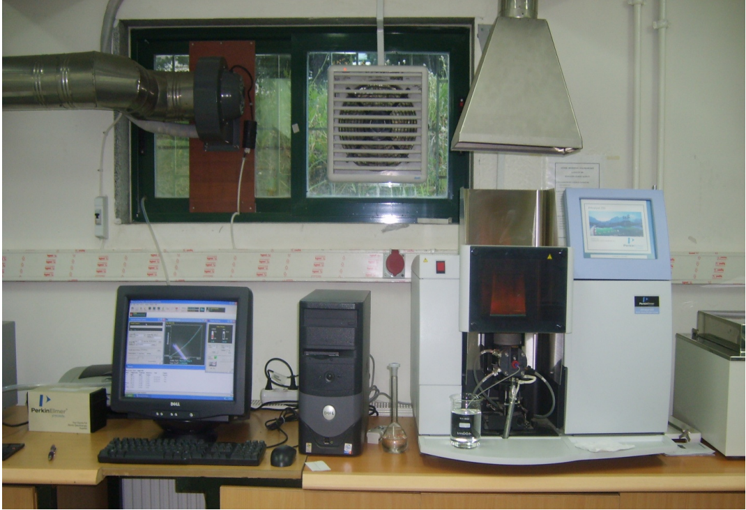
Şekil 9.2 Atomik absorpsiyon deney düzeneęi
