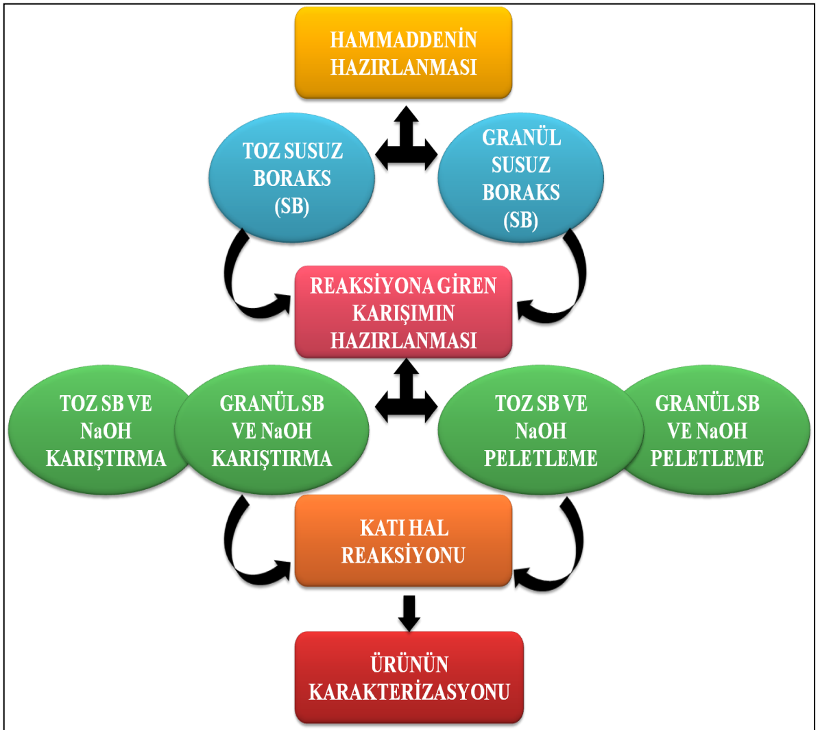
Şekil 7. 13 Katı hal üretiminin deneysel yöntemi
