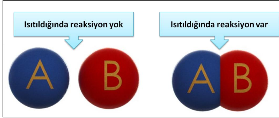
Şekil 5. 1 Faz sınırının katı hal reaksiyonundaki rolü (Ropp, [50])
