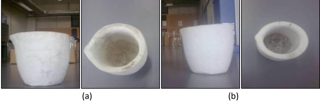
Şekil 7. 9 Kullanılan yüksek sıcaklık krozeleri (a) \text{ZrO}_2 , (b) \text{Al}_2\text{O}_3
