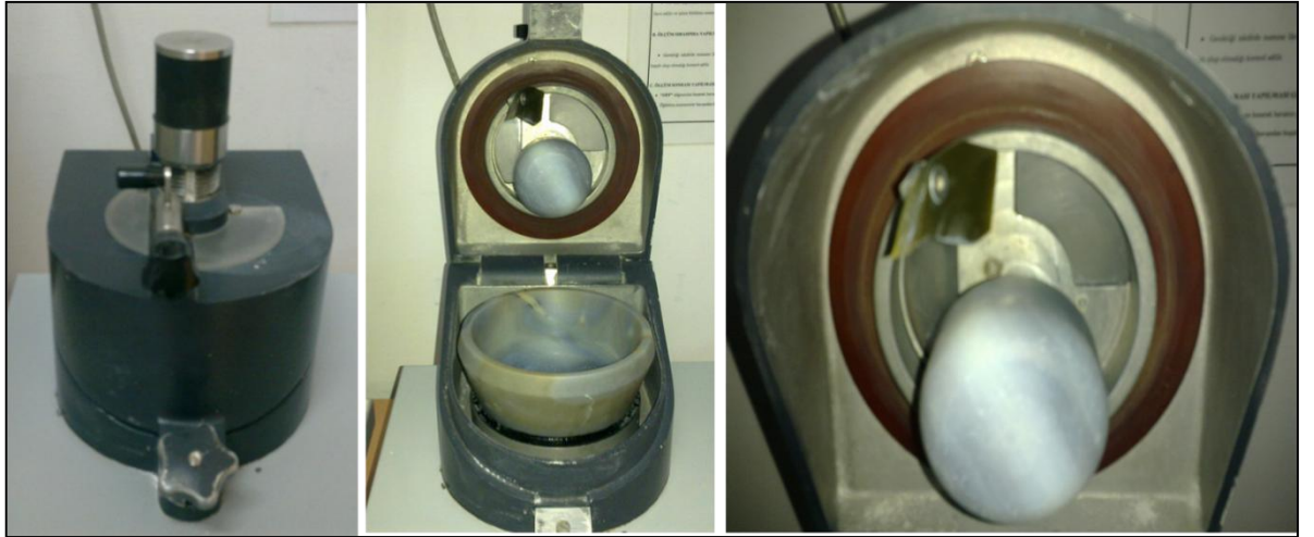
Şekil 7. 8 Agat öğütücü (a) Kapalı, (b) Açık ve (c) Bıçağının görüntüsü
