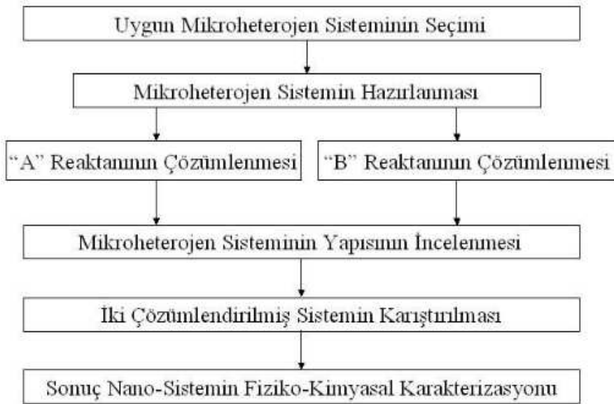
Şekil 5.6 Mikroheterojen sisteme ait akış diyagramı [31]
