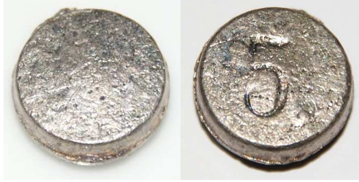
Şekil 3.1 1,2 cm çapında, 5 g ağırlıkta bir bizmut külçesi [15]
