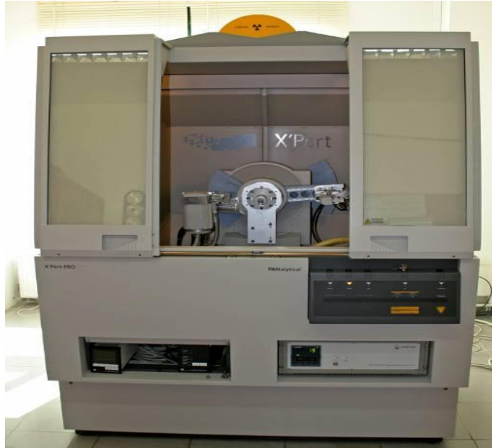
Şekil 7.2 Laboratuvarımızda kullanılan XRD cihazının görüntüsü
