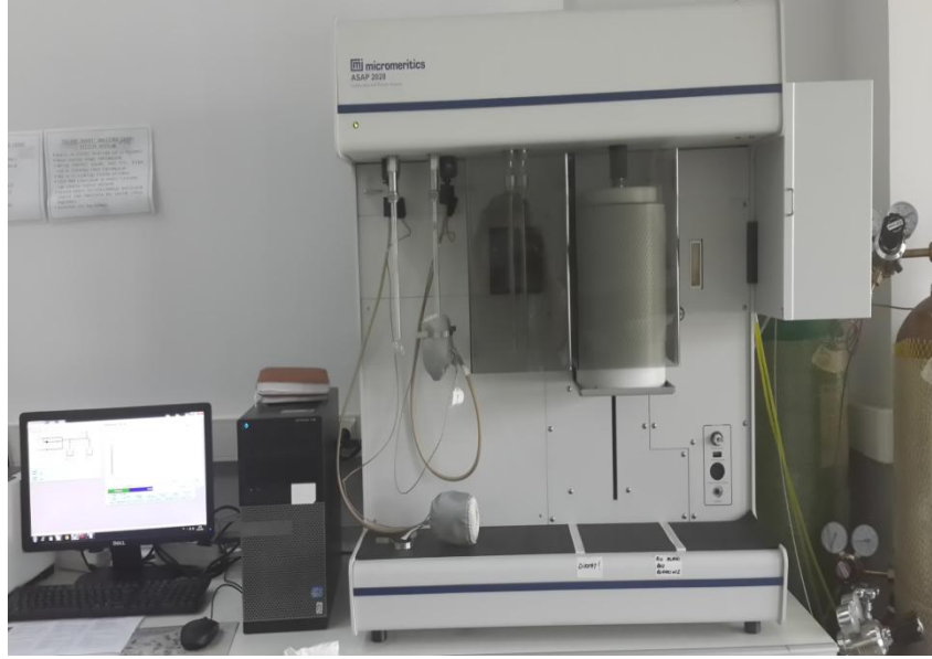
Şekil 7.5 Analizlerde kullanılan BET cihazı görüntüsü
