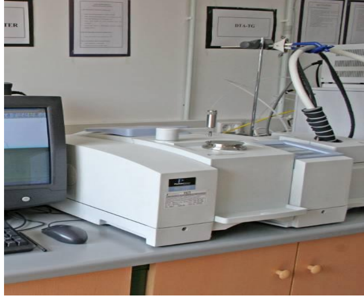
Şekil 7.3 Laboratuvarımızda kullanılan FT-IR cihazı görüntüsü
