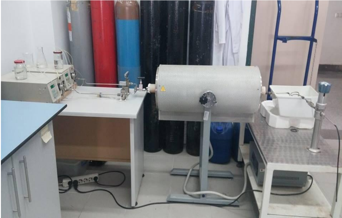
Şekil 5. 5 SCWO Deneysel düzeneğinin fotoğrafı
