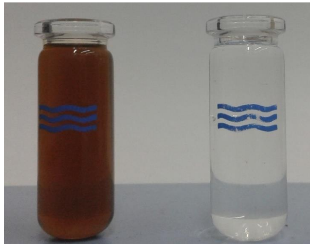
Şekil 6. 16 Çöp sızıntı suyu ve en yüksek arıtımın gerçekleştiđi deneyden elde edilen numune (T=600°C, t=150 s, P=100 bar, [H 2 O 2 ]= 90,9 ml/L)
