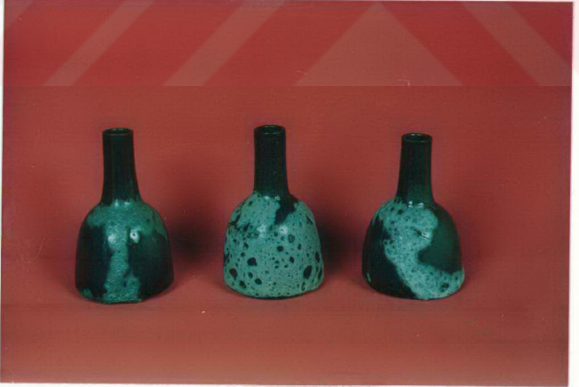
Şekil.23: 43 no'lu sır (sağdaki kalın sırlanmış, ortadaki ince sırlanmış) ve 44 no'lu sıranın (soldaki), 29 no'lu sır ile birlikte kullanımı.(bir kere sırlı pişirim.)
