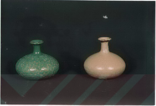
Şekil.24: (sağdaki) 45 no'lu sırın MnO_2 ile renklendirilmesi, (soldaki) 29 no'lu CuO 'li sır ile 45 no'lu MnO_2 'li sırı birlikte kullanımı.
