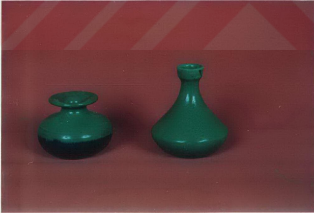
Şekil.26: 28 no'lu üleksitli sırın Cr_2O_3 'li uygulaması.
