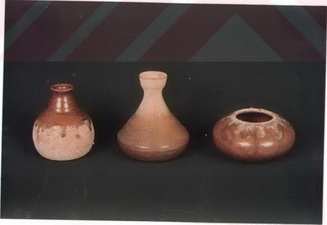
Şekil.21: 39 no'lu sıra uygulanan MnO_2 'li renklendirme.(ortadaki 3, sağdaki 4, soldaki 5 no'lu deneme.) ve(açık renkteki kısımlar) 12 no'lu borakslı sır.
