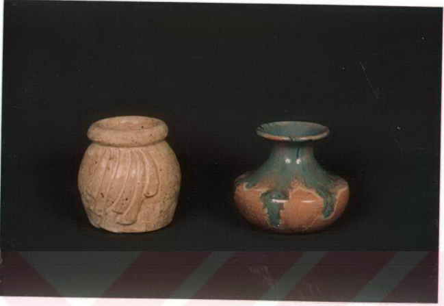
Şekil.20: 39 no'lu sıra uygulanan MnO_2 'li renklendirme.(soldaki 1, sağdaki 2 no'lu deneme.)
