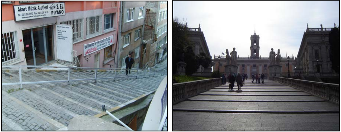
Resim 4.25 Geniş (en) ve uzun merdivenli mekanlarda çoğunlukla basamak yüksekliğinde bir kademelenme veya geniş ayak basış yüzeyleri kullanılarak basamak sayısı azaltılır ve düz bir yolda yürüme hissi sağlanır; sol; Nüzhetiye Caddesi, Beşiktaş, İstanbul (2007); geniş basamaklar ile tırmanış zorluğunu azaltmak. Sağ; Capitoline Hill, Roma, İtalya; geniş ve uzun merdivenli mekanlar çoğu kez anıtsal bir ölçek gösterir ve çevredeki tarihi yapılar ile bir turizm mekanı kimliği taşır.
