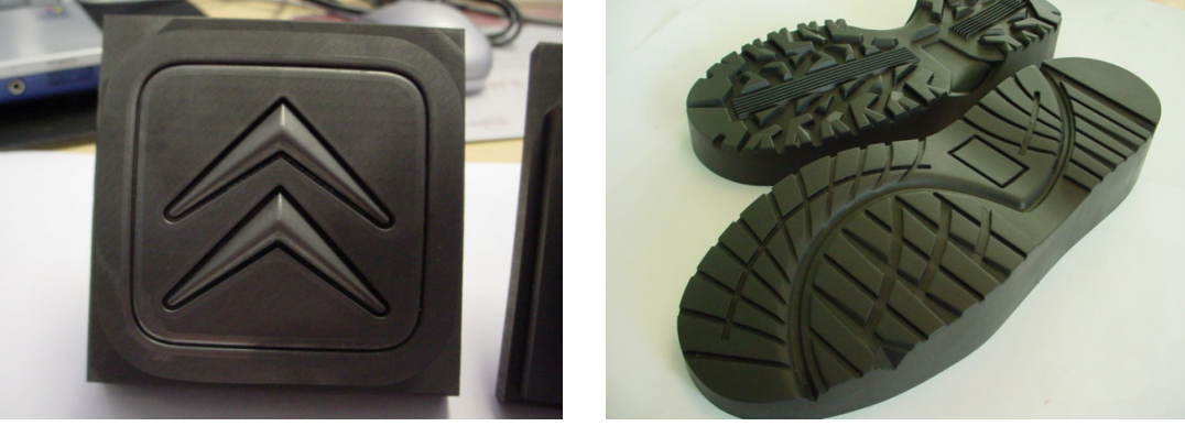
Şekil 3.17: Dalma erezyonda kullanılacak elektrot örnekleri.
