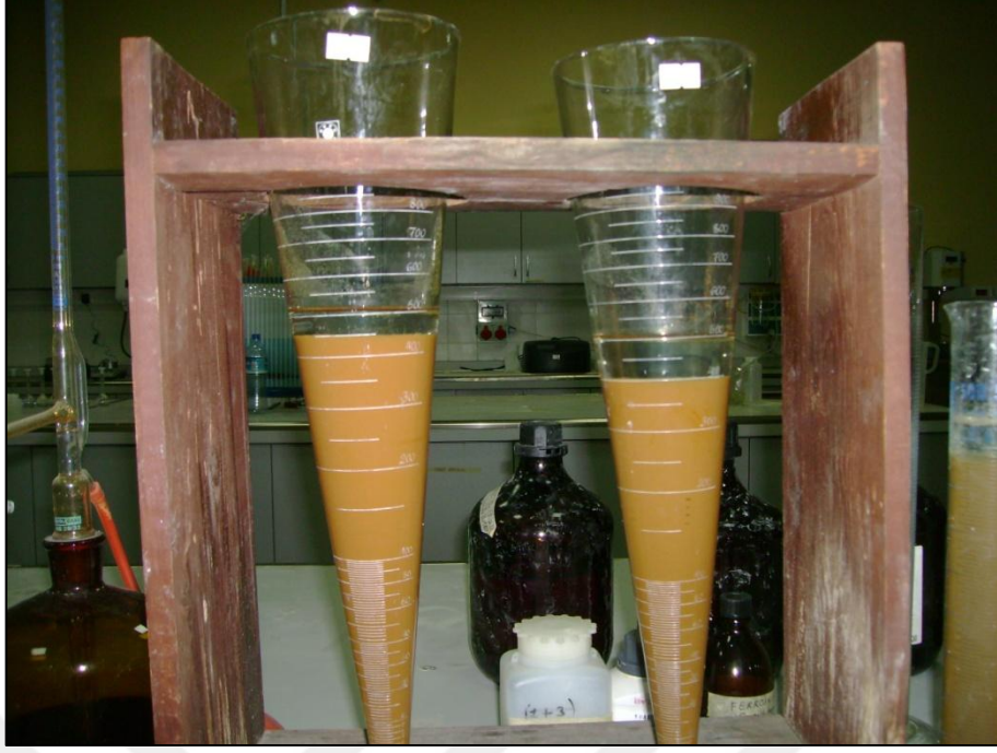
Şekil 3.6 Fenton uygulamasında son çöktürme işlemi
