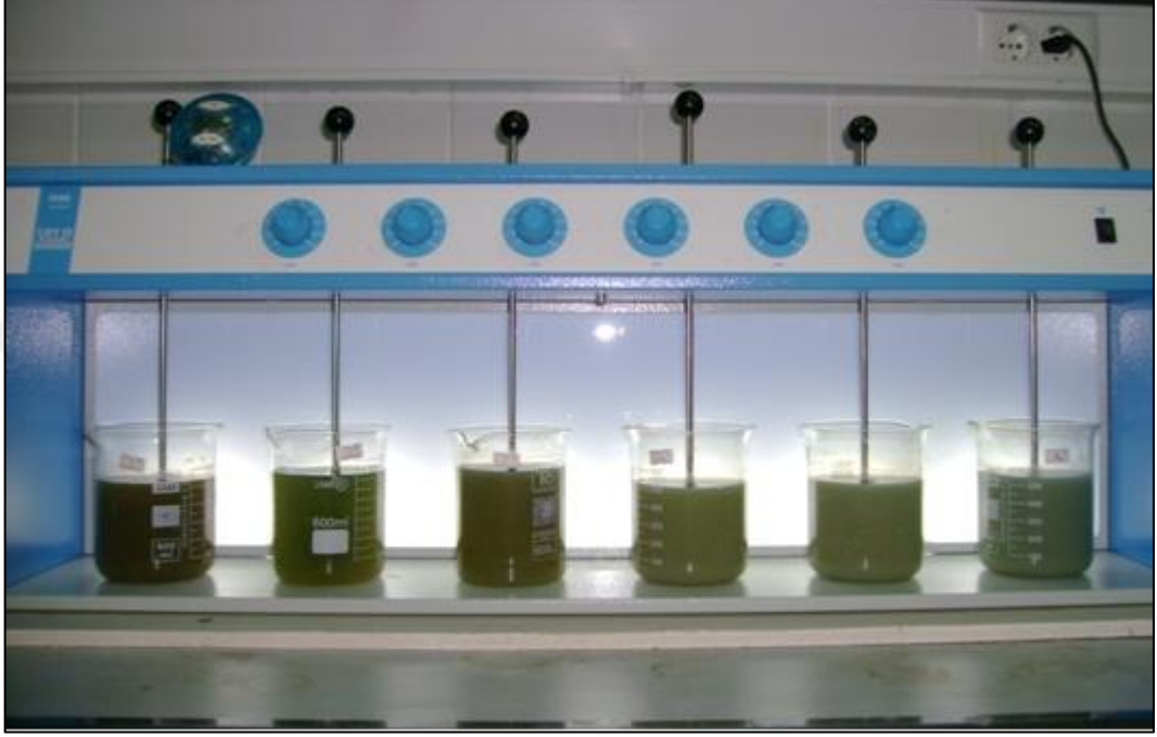
Şekil 3.5 Fenton uygulamasının yapıldığı jar test düzeneği
