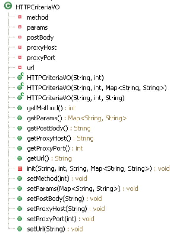
Şekil 4. 17 HTTPCriteriaVO modelinin yapısı
