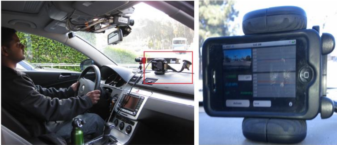
Şekil 1.7 MIROAD sisteminde telefonun araç içerisindeki konumu [6]
