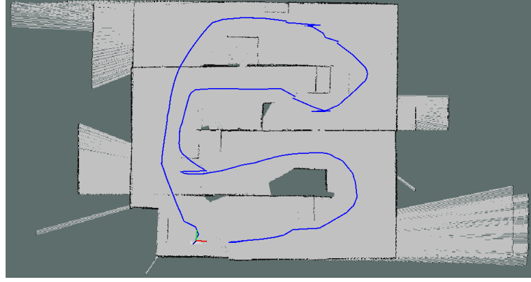
Şekil 7.24 “map_update_interval” değerinin 2, diğer gMapping parametrelerinin varsayılan olduğu durumda 41 cm/sn hızla gezilen bag dosyası üzerinden odometrilik gMapping sonuçları ve gezinmesi
