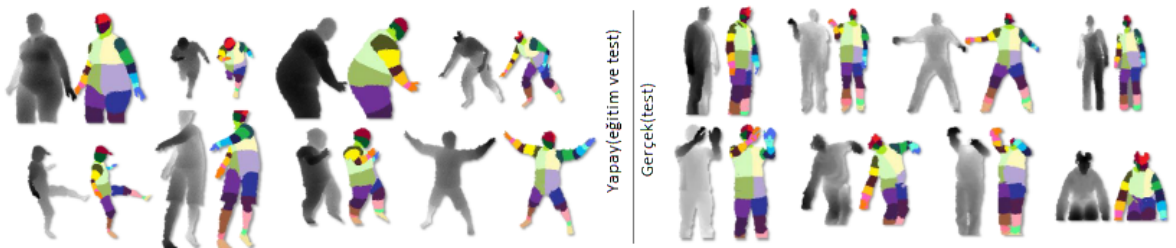
Şekil 2.18 Yapay ve gerçek derinlik görüntüleri ve etiketlenmiş vücut bölümleri [39]
