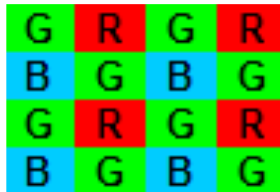
Şekil 2.9 Bayer renk filtresi şablonu [32]
