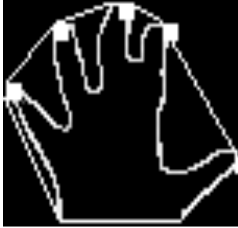
Şekil 2.56 El kenar görüntüsünden bulunan dış bükey örtü
