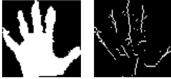
Şekil 2.57 İskeletleme işleminden önce ve sonra el görüntüsü
