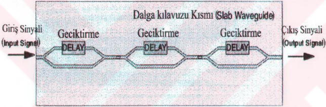
Şekil 5.3.1 Kademeli Mach - Zehnder interferometrelerini kullanan filitre.Dutton
