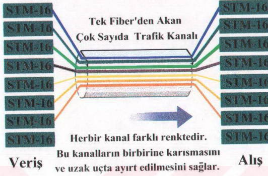
Şekil 5.2.2 WDM sisteminin STM-16 hızındaki her bir kanalını farklı renklerle belirleyerek karşı tarafa iletebilme durumu
