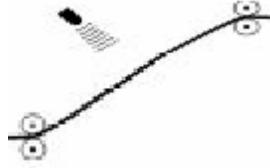
Şekil 2.7 Otomasyon sistemlerinde bağlantı kopma algılanmasında ultrasonik kullanımı
