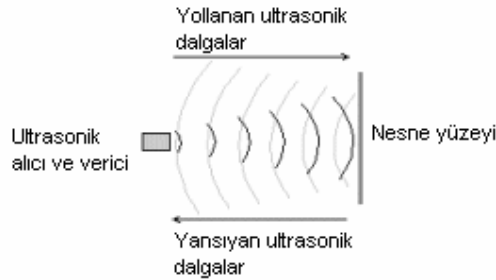
Şekil 3.1 Ultrasonik vericiden gönderilen ve nesne yüzeyinden geri gelen ultrasonik ses dalgaları
