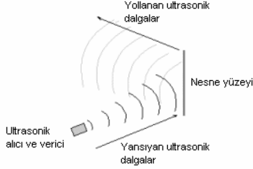
Şekil 3.2 Ultrasonik algılayıcıdan gönderilen ultrasonik ses dalgalarının ultrasonik alıcıya ulaşamama durumu
