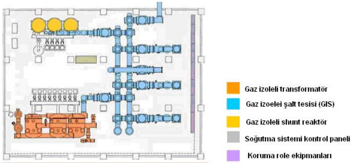
Şekil 5.3 Tamamen gaz izoleli bir tesis (Toshiba)
