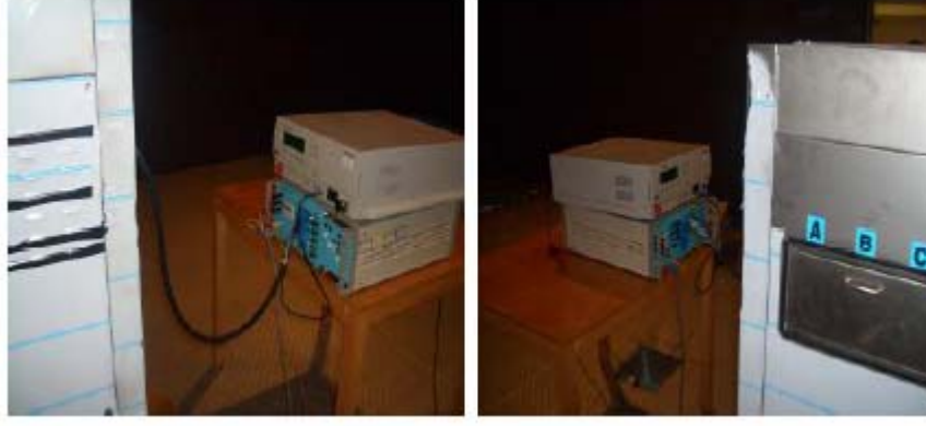
Şekil 4.13 Ani yükselmelere karşı bağışıklık test düzeneđi
