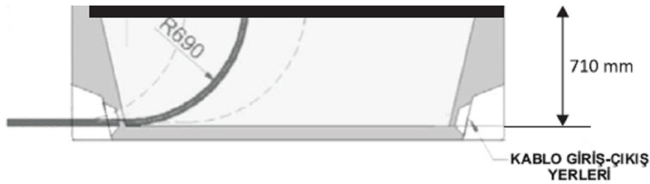
Şekil 2.20 Kablo giriş-çıkış yerleri ve bükülme yarıçapı
