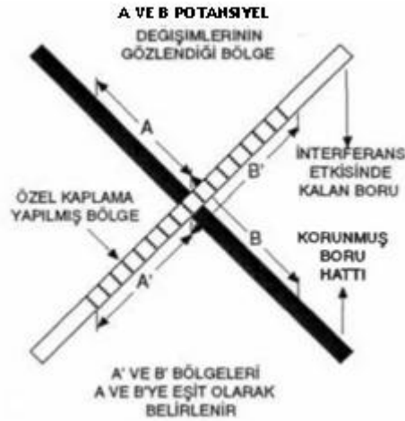
Şekil 2.29 Enterferans etkisinin kaplama yapılarak önlenmesi
