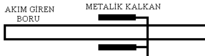
Şekil 2.32 Metalik kalkan ile koruma
