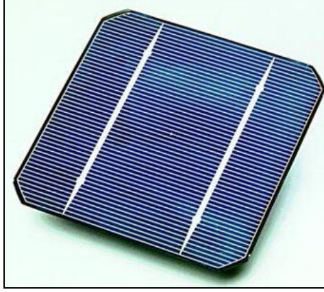
Şekil 3.20 Tipik Bir Silisyum Güneş Pilinin Ön Yüzü
