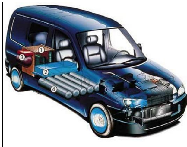
Şekil 2.36 Bir yakıt pilli otomobilin iç yapısı
