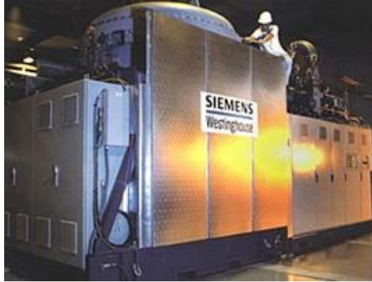
Şekil 2.29 Gaz türbinli,yakıt hücreli kojenerasyon sistemi
