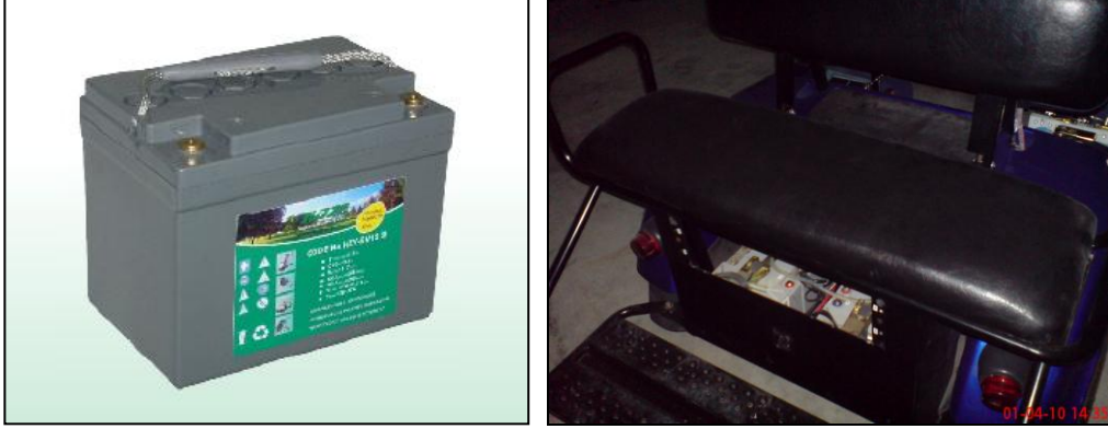
Şekil 5.8 Batarya grubunun araç üzerindeki yerleşimi
