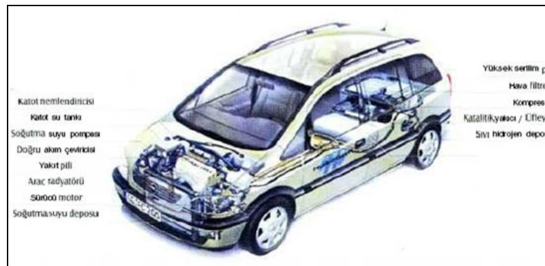
Şekil 2.34 Hidrojen yakıtlı Opel Zafira'nın yakıt pili, yakıt tankı ve aksesuarları
