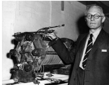
Şekil 2.26 1959 yılında üretilen 5 kW alkalin yakıt hücresi
