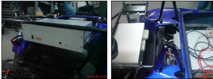
Şekil 5.7 Yakıt pili kontrol ünitesinin araç üzerine yerleşimi
