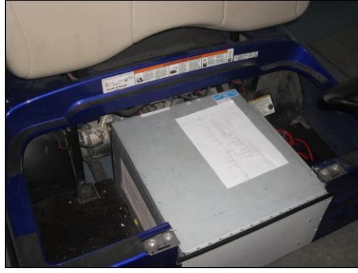
Şekil 5.5 Yakıt pili ünitesinin araca yerleşimi
