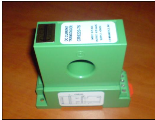
Şekil 5.18 Projede kullanılan akım sensörlerinden bir tanesi
