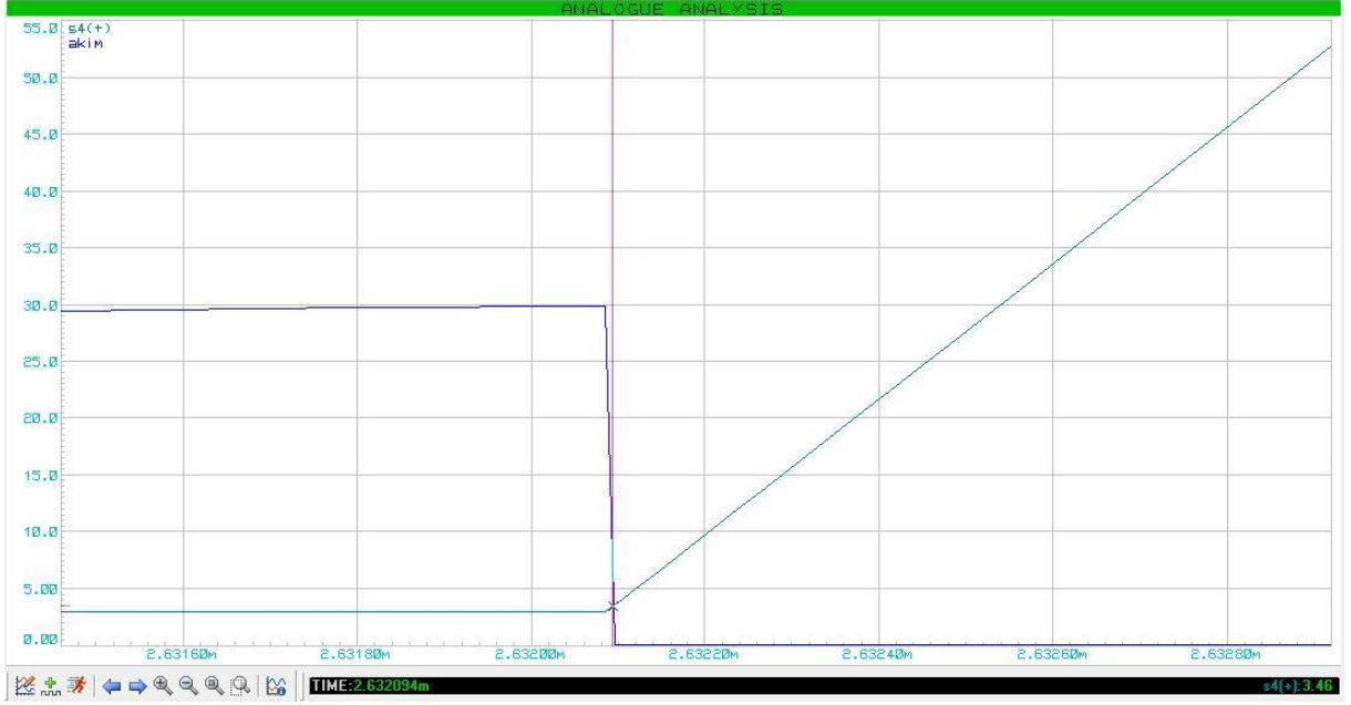
Şekil 5.11 Yumuşak anahtarlamalı inverterde S_4 anahtarının iletimden çıkma anındaki akım ve gerilimdeki değişimler. (5A/div, 5V/div, 200ns/div )
