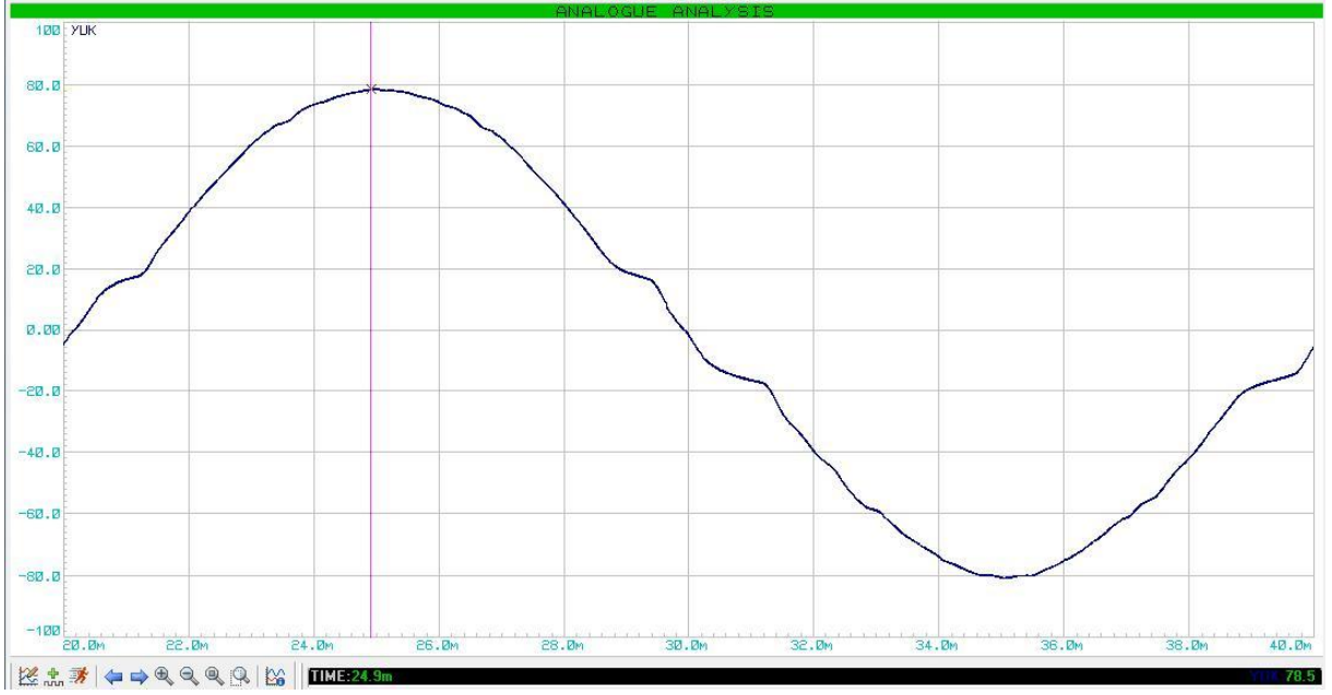
Şekil 5.13 Sert anahtarlmalı inverter devresi çıkış gerilimi. (20V/div, 2ms/div)
