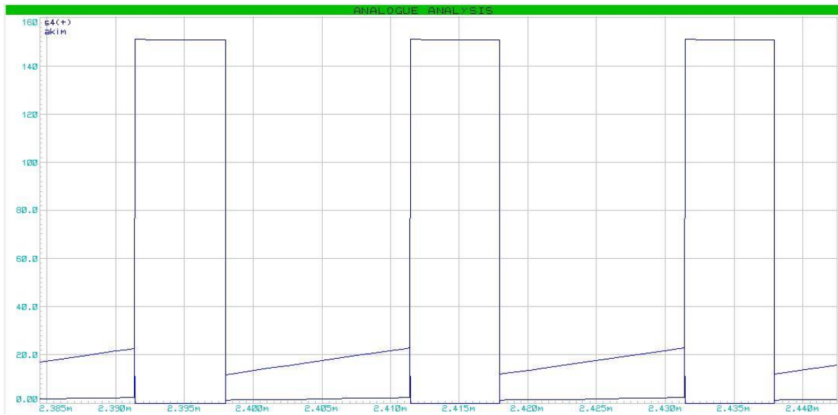
Şekil 5.8 Sert anahtarlmalı inverterde S_4 anahtarına ait akım ve gerilim değişimleri. (20A/div, 20V/div, 5us/div)
