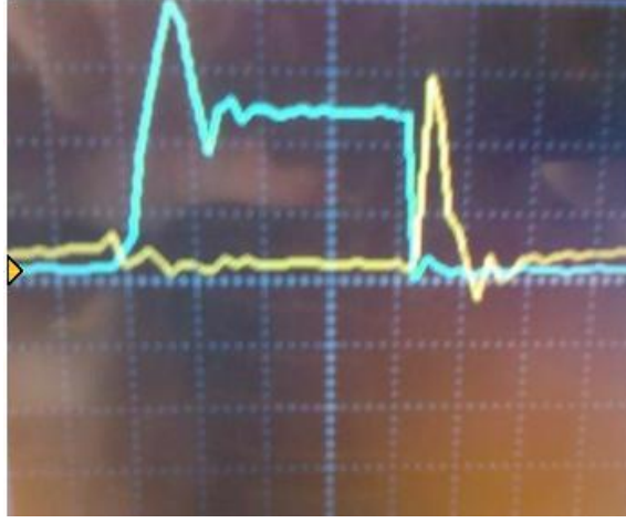
Şekil 6.9 S_1 anahtarı üzerindeki akım ve gerilim değişimleri. (Kanal 1: 2A/div, kanal:2 50V/div, yatay eksen: 2.5us/div)
