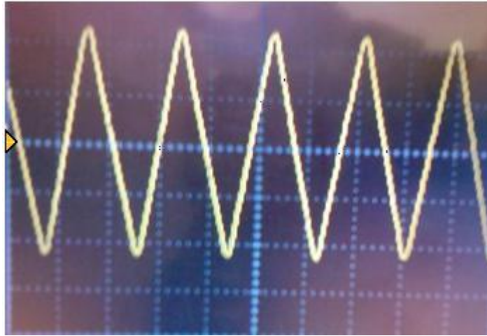
Şekil 6.3 Üçgen kontrol gerilimi. (5V/div, 10us/div)
