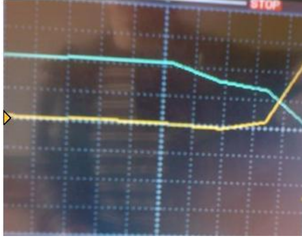
Őekil 6.6 Yumuřak anahtarlama modunda S_1 anahtarının ilettime girme anındaki akım ve gerilimdeki deėiřimler. (Kanal 1: 1A/div, kanal 2: 50V/div, yatay eksen: 250ns/div)
