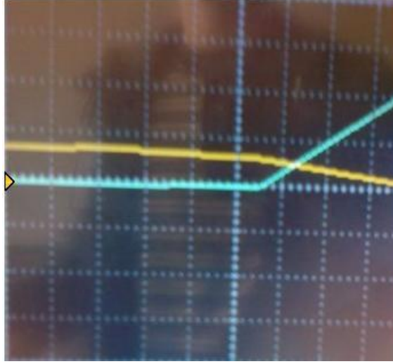
Şekil 6.7 Sert anahtarlama modunda S_1 anahtarının kesime girme anındaki akım ve gerilimdeki değişimler. (Kanal 1: 1A/div, kanal 2: 50V/div, yatay eksen: 50ns/div )
