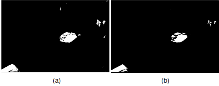
Şekil 4.3 Aşınma işleminin etkisi a) Arkaplan çıkarımı sonrası b) Aşındırılmış görüntü
