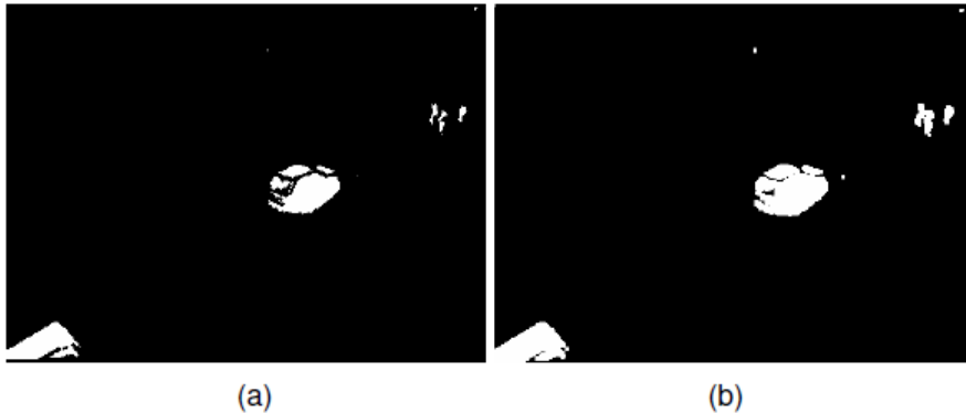
Şekil 4.4 Genişleme işleminin etkisi a) Aşındırılmış görüntü b) Genişlemiş görüntü
