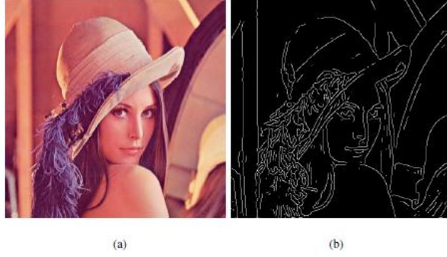
Şekil 3.2 Canny kenar bulma metodu sonucu a) orjinal resim b) kenar gösterimi
