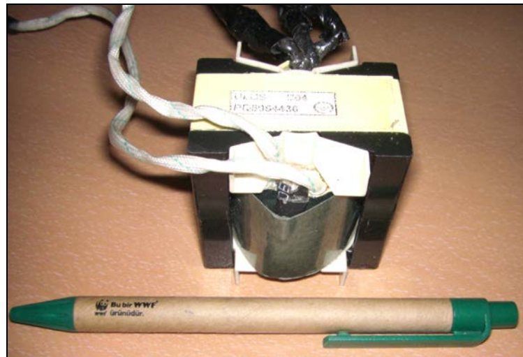
Şekil 6.17 Tasarlanan yüksek frekans transformörü
