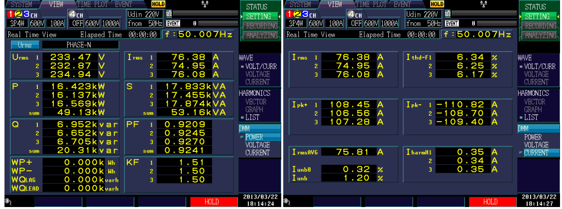
Şekil 6. 29 Filtresiz 12-Darbeli Sistemin %75 yüklenmesi durumunda (a) Giriş Gerilim, Akım Dalga Şekilleri ve Gerilim Değerleri, (b) Giriş (R,S,T)Akımı Toplam Harmonik Distorsiyon Değerleri, (c) Giriş Güç Faktörü ve Akım Değerleri
