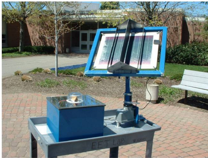
Şekil 1.1 Tek eksenli sabit konumlandırılmalı güneşi takip eden sistem.
