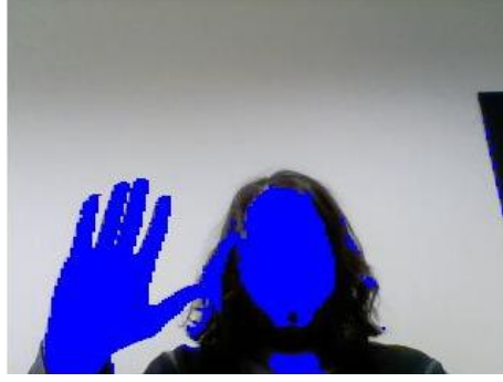
Şekil 2. 5 Şekil 2.3’de gösterilen örnek görüntünün ten rengi tespiti yapılmış hali
