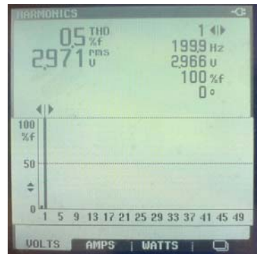
Şekil 5.2 Referans harmonik analizör ile 4 V, 200 Hz sinüs işareti ölçümü
