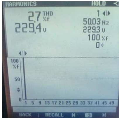
Şekil 5.6 Referans harmonik analizör ile 50 Hz şebeke gerilimi ölçümü
