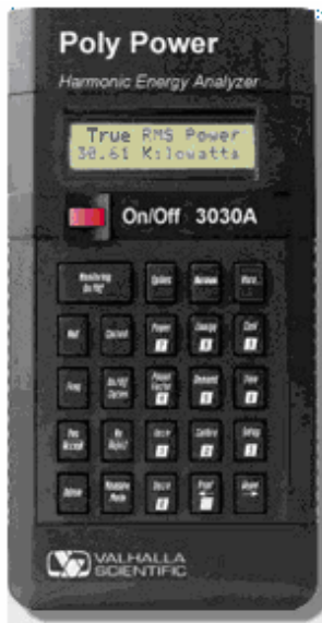
Şekil 2.4 VALHALLA 3030A ölçüm cihazı ve bir harmonik ölçümü ekran çıktısı
