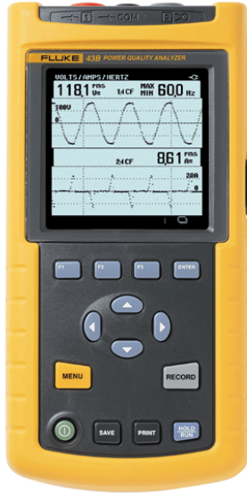
Şekil 2.5 FLUKE 43B ölçüm cihazı ve bir harmonik ölçümü ekran çıktısı
