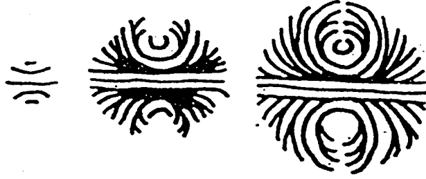
Şekil 2.2. Dallanma Frekans Teorisine Göre Bir Grafit Küresinin Büyümesindeki Kademeler.
