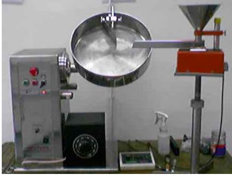
Şekil 5.1 Multipex Marka Küresel Pelet Makinesi ve Apex Vibratory Feeder marka vibratör cihazı
