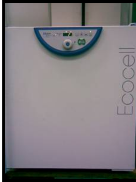
Şekil 5.4 Şekillendirilen küresel peletlerin kurutma işlemlerinin yapıldığı etüv
