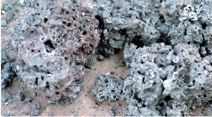
Şekil 3.6 Sinterleme işlemi sonucunda elde edilen sinter ürünü [9].
