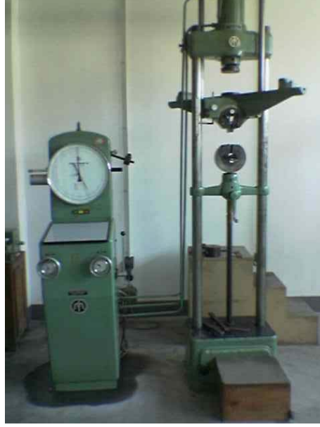
Şekil 5.3 Peletlerin mukavemet testini ölçmek için kullanılan Mohr Bfederhoff AG marka üniversal tip hidrolik çekme makinesi
