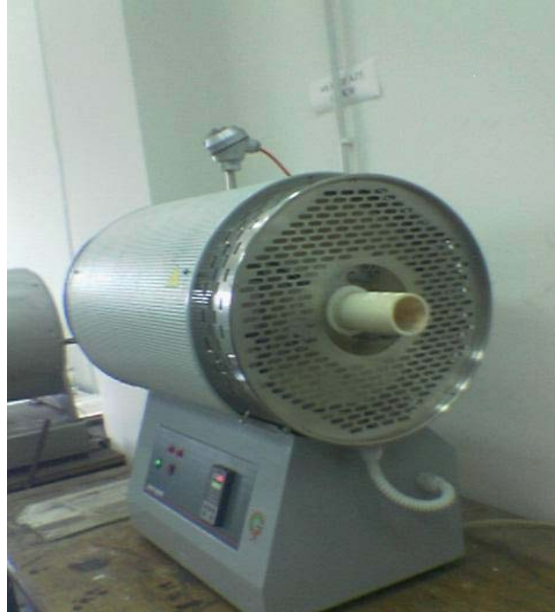
Şekil 5.2 Pişirme işleminin yapıldığı Protherm marka tüp Fırın
