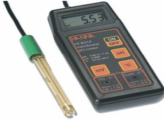
Şekil 4.5 KOSGEB iktelli Metal Laboratuvarı Hana Marka pH metre cihazı.
