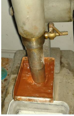
Şekil 4.2 YTÜ Metalurji ve malzeme mühendisliği bölümündeki Hammade ve Cevher Hazırlama Laboratuvarında bulunan flotasyon makinası ve flotasyon işlemi.
