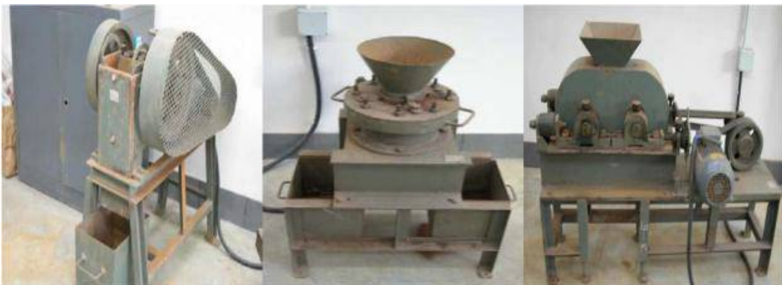
Şekil 4.1 YTÜ Metalurji ve malzeme mühendisliĐi bölümündeki Hammadde ve Cevher Hazırlama Laboratuvarında bulunan çeneli kırıcı, konili kırıcı ve merdaneli kırıcılar.
