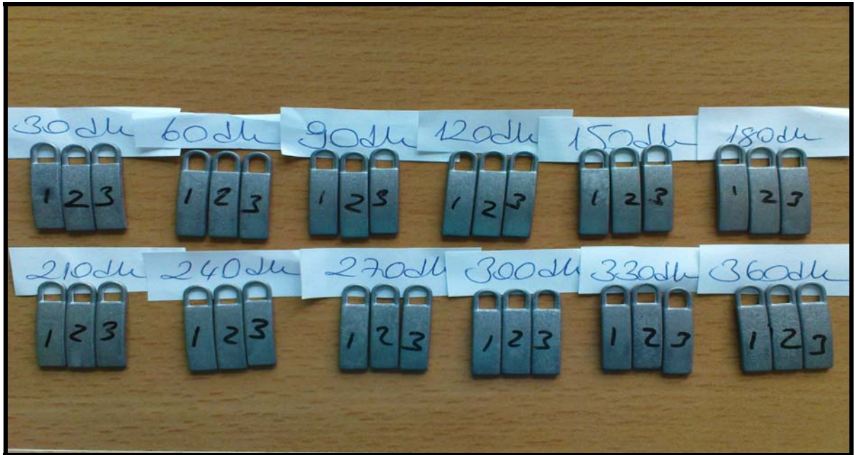
Şekil 7.4 2 Numaralı seramik bağlayıcılı ithal aşındırıcıyla aşındırılan deney numuneleri.
