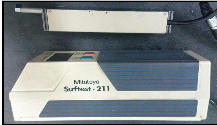
Şekil 6.13 Mitutoyo surfTest – 211 yüzey pürüzlülük ölçüm cihazı.
