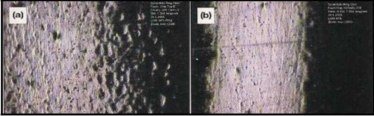
Şekil 5.6 Aynı tip 2 yüzüğün farklı 2 aşındırıcı ile 5 saat parlatılmasından sonraki 2 farklı yüzey görüntüsü. (Moser, 2001)
