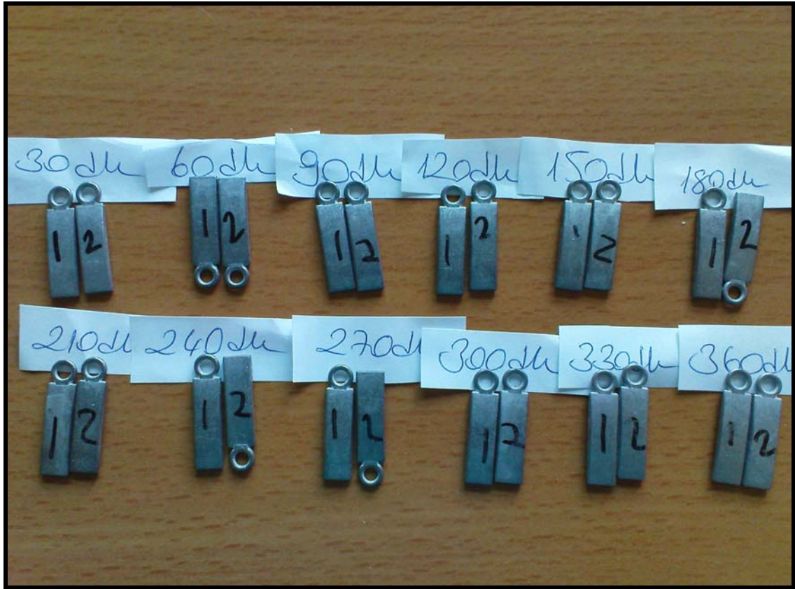
Şekil 7.18 8 Numaralı aşındırıcıyla aşındırılan deney numuneleri.
