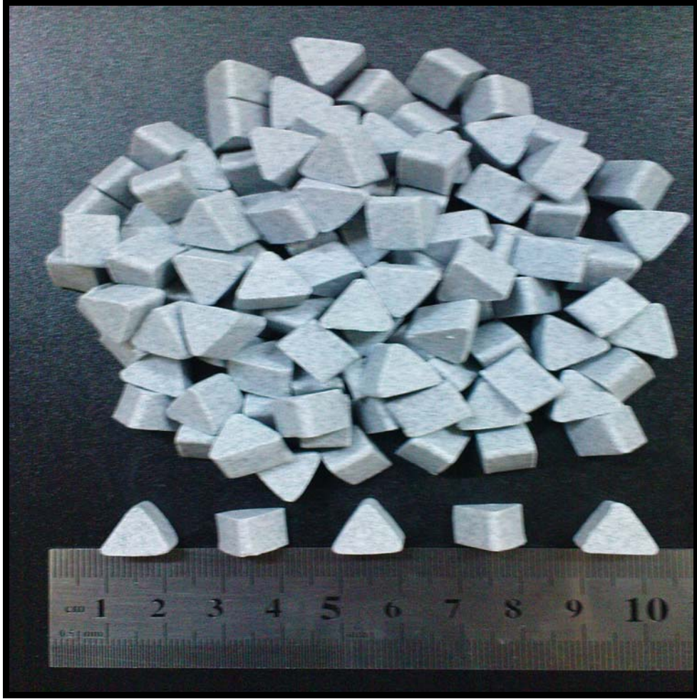
Şekil 6.2 2 Numaralı seramik bağlayıcılı ithal aşındırıcı.
