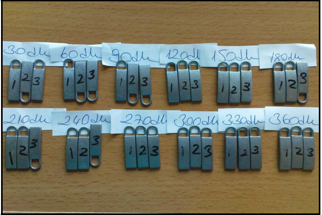
Şekil 7.2 1 Numaralı plastik bağlayıcılı ithal aşındırıcıyla aşındırılan deney numuneleri.
