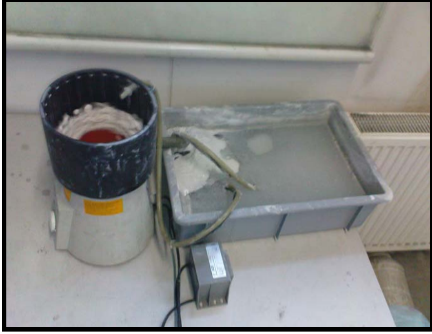
Şekil 6.11 Çalışma esnasındaki ECO-mini wet aşındırma cihazı.
