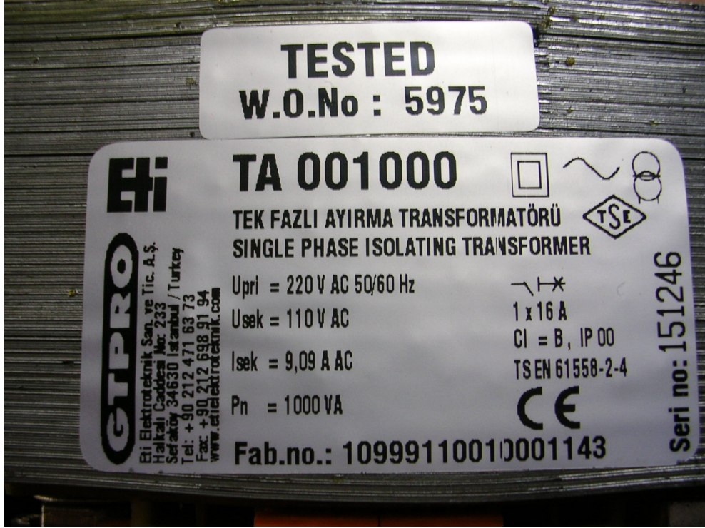
Şekil 5.3 (1) kVA lık transformatörün etiket değerleri ( V_1=110 V_2=220 ... )
