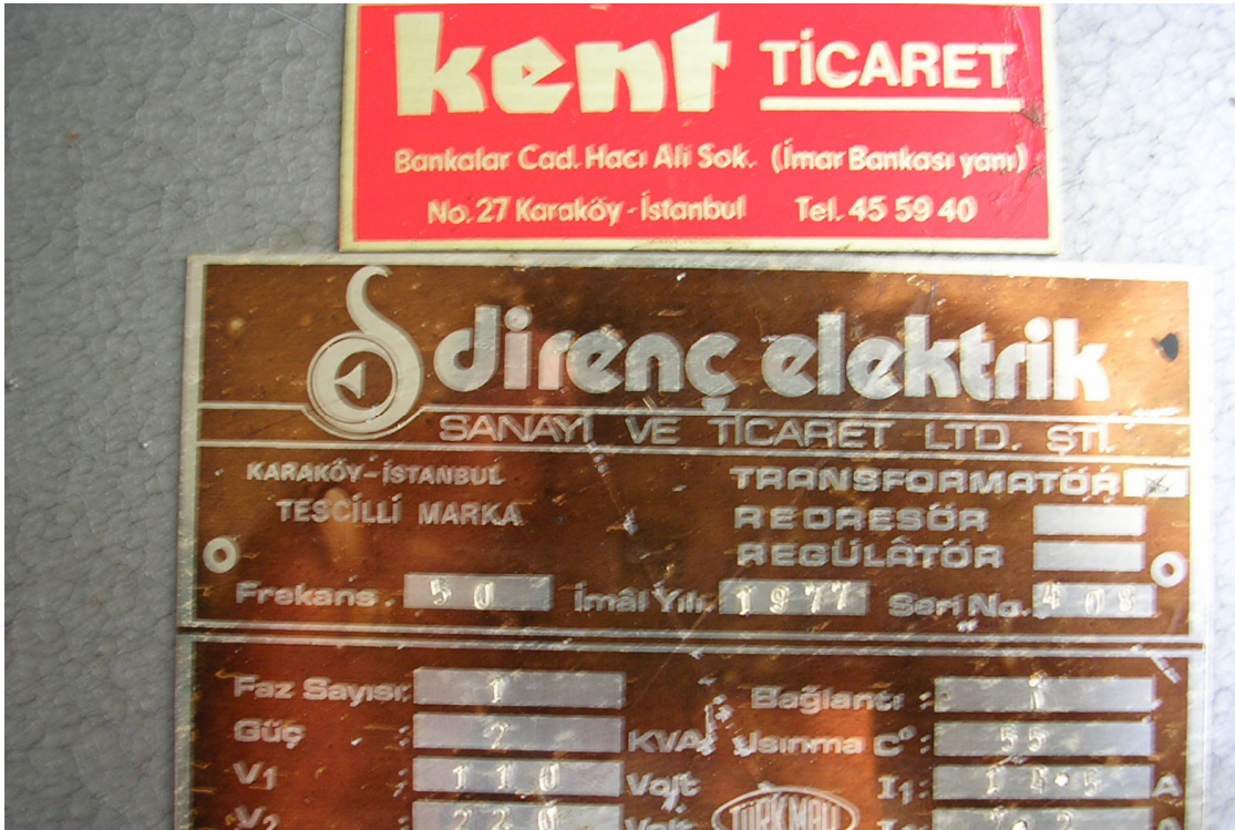
Şekil 5.8 (2) kVA lık transformatörün etiket değerleri ( V_1=110 V_2=220 ... )
