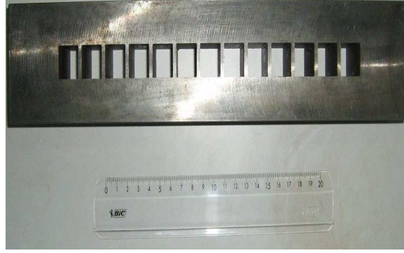
Şekil 3.6 Tane küçültücü numunelerinin dökümünde kullanılan metal kalıp
