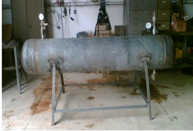
Şekil 7. 16 Hidrostatik test öncesi parça hazırlığı
