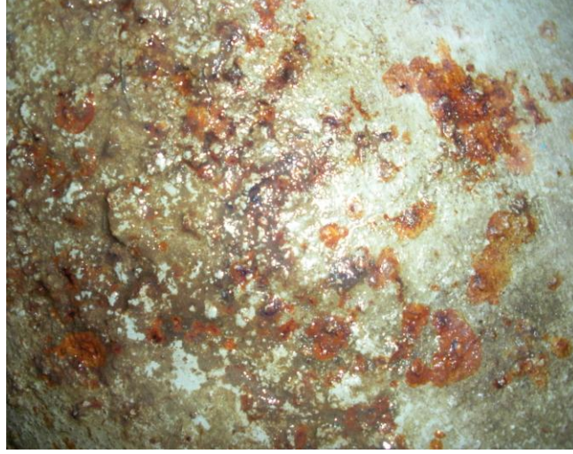
Şekil 6. 16 Boyanın kabarcıklaşıp sıvı ile dolması
