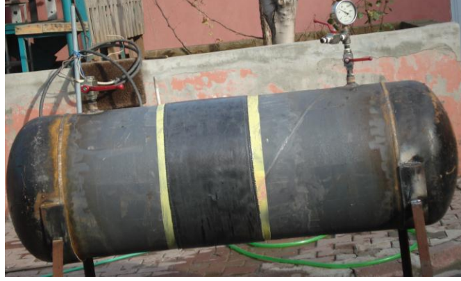
Şekil 7. 19 Hidrostatik test sonrası kompozit tamir malzemesi
