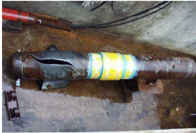
Şekil 7. 20 Yüksek basınçlı hidrostatik test sonrası boruda meydana gelmiş olan deformasyon. Kompozit malzemede deformasyon yoktur.
