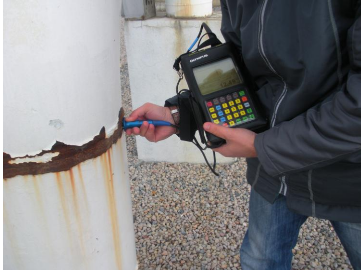
Şekil 7. 11 Gazlı boruda ultrasonik cihazla metal et kalınlığı ölçümü yöntemi.
