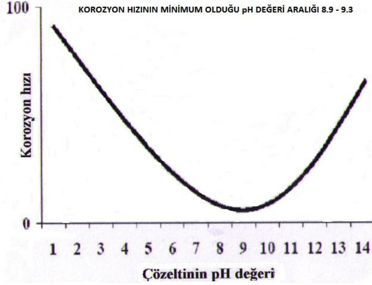
Şekil 5. 17 Çözelti pH değerinin korozyon hızına olan etkisi [25]
