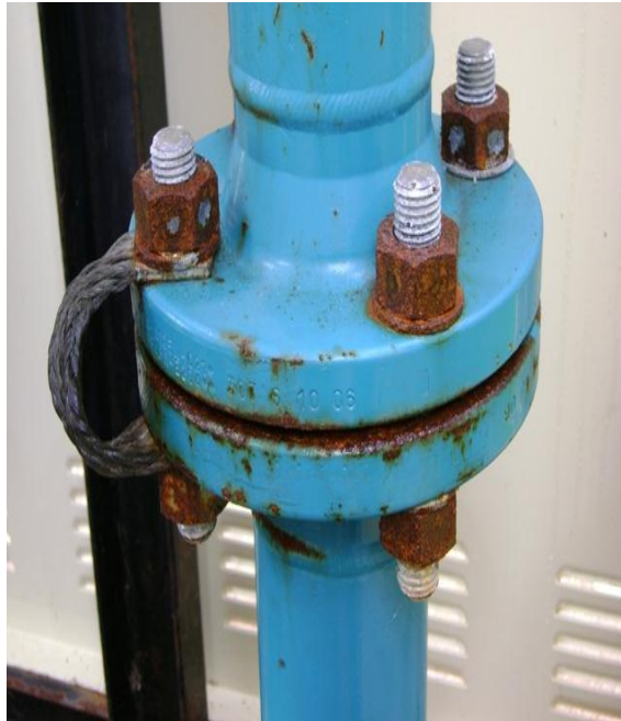
Şekil 5. 21 Flanşta galvanik çift oluşturmuş saplama ve somun
