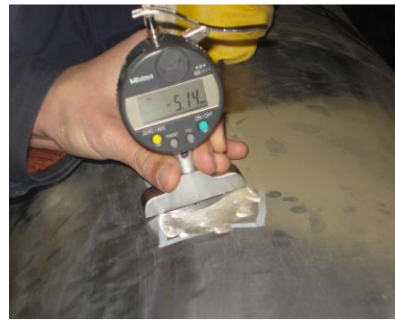
Şekil 7. 17 (a) Boruya verilmiş hasar (b) Hasar derinliğinin komperatör ile ölçülmesi
