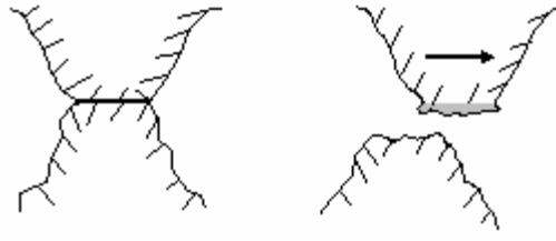
Şekil 5.2 Adhezif aşınma olayının şematik gösterimi [85]
