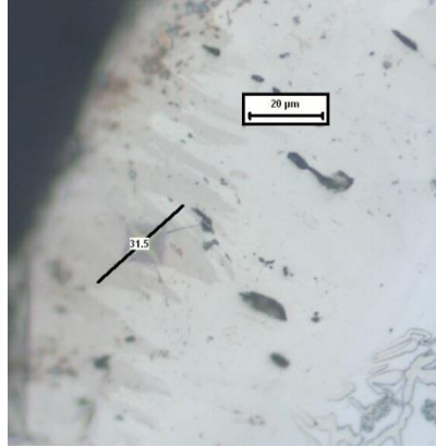
Şekil 6. 20 Borür tabakası üzerinde kırılma tokluğu hesabı için çatlak boyunun ölçümü
