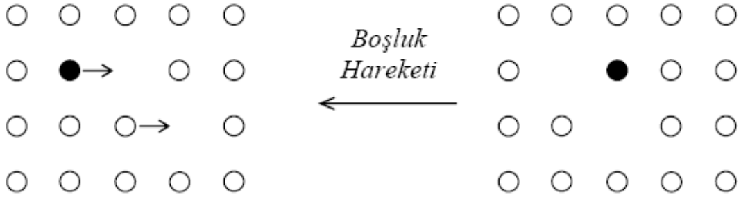
Şekil 4.2 Boşluk difüzyonunu şematik gösterimi [72]
