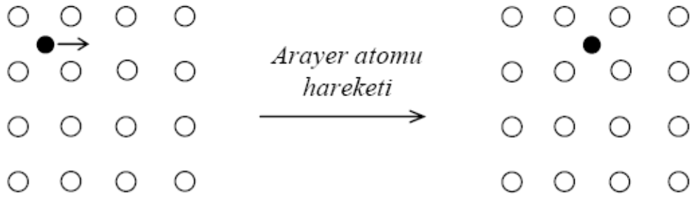
Şekil 4.1 Arayer difüzyonunun şematik gösterimi [72]
