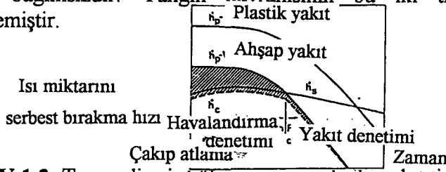
Sekil IV.1.2 ; Tam gelişmiş bölme yangınında iki yakıt tipinin zamana karşı serbest kalan ısı miktarının olası hızı
