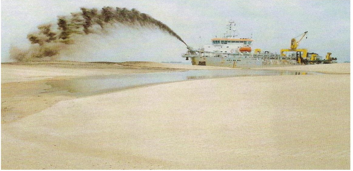
Şekil 4.2 Traylerli emme mavnalı tarayıcı (Bray vd., 1997).
