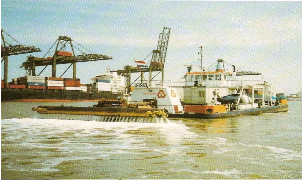
Şekil 4.8 HAM su enjeksiyonlu tarayıcı (Bray vd., 1997)
