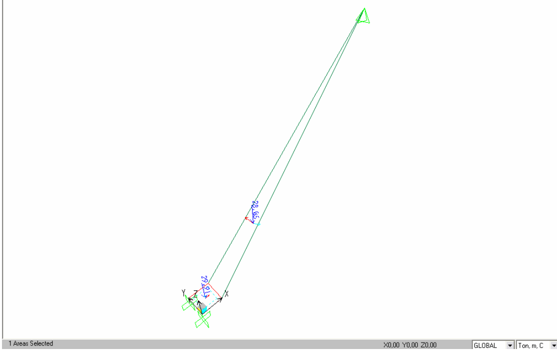
Şekil 4.18: 1m genişliğindeki bunker ve kirişe gelen malzeme yükü
