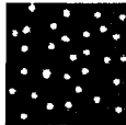
Şekil 6.5 Örnek görüntüye dairesel yapı elemanı ile açılma uygulanması sonucunda ortaya çıkan görüntü.
