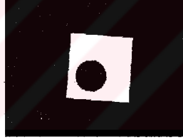
Şekil 5.5 Örnek görüntüye disk yapı elemanı ile erozyon uygulanması sonucu ortaya çıkan görüntü.
