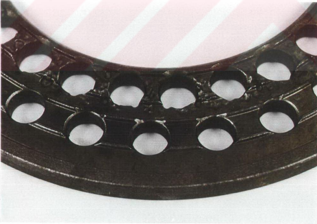
Şekil 7.3 Hasara uğrayan kalın modül görüntüsü
