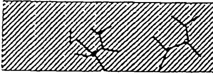
Şekil 6.14 Gerilmeli korozyon sonucu oluşan çatlaklar
