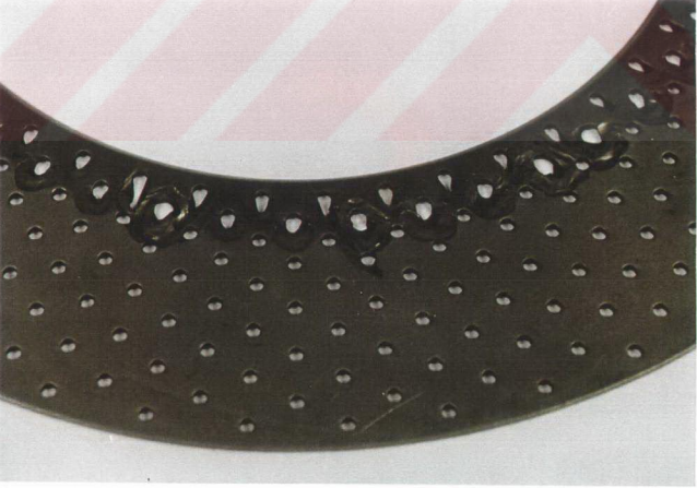
Şekil 7.5 Hasara uğrayan ince modül görüntüsü
