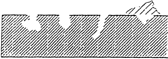
Şekil 6.10 Tipik çukur korozyonu görünüşü
