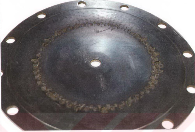
Şekil 7.6 Hasara uğrayan diyafram görüntüsü
