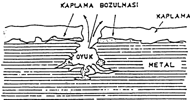
Şekil 6.24 Kaplama bozukluğu nedeniyle oluşan korozyon
