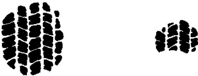
Şekil 5.34 Viraj manevrası esnasında, bir taşıtın lastik temas bölgeleri duran taşıta göre daha farklıdır. Dış lastikler iç lastiklere oranla, yanıl yük transferine bağılı olarak daha fazla yüklüdür.
