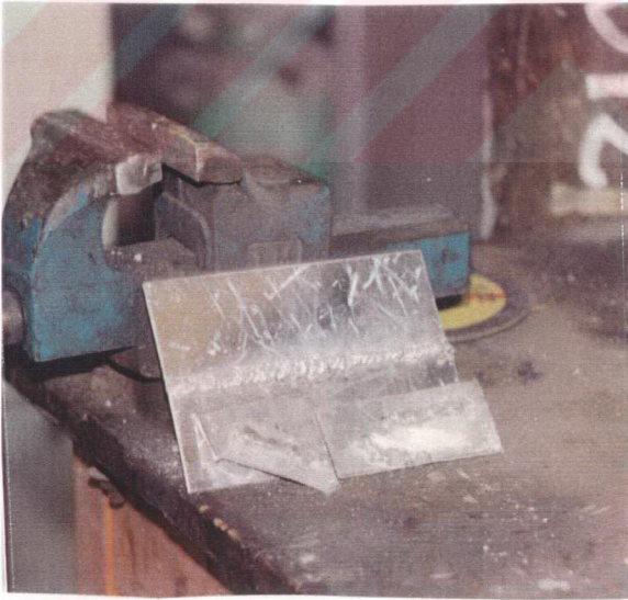
- MIG yöntemi ile hava ortamında yapılan alüminyum kaynağı
