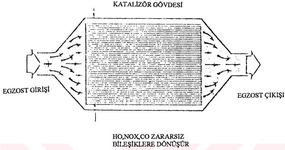
ŞEKİL 14.11 Tipik katalizatör dizaynı ( Exhaust Cleaning For Internal Combustion Engines, UNIKAT, 1986 )
