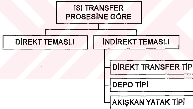
Şekil 2.3 Isı deęiřtiricilerin, ısı transfer prosesine göre sınıflandırılması ( Tarakçı, 1991 )
