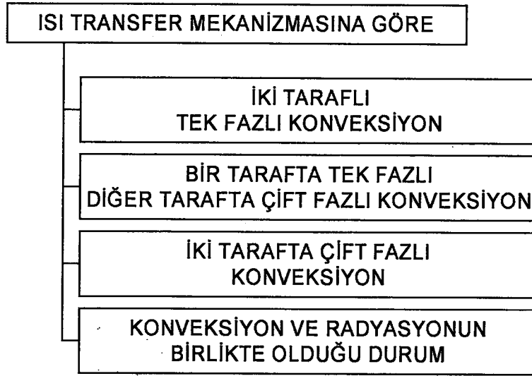
Şekil 2.8 Isı deęiřtiricilerin, ısı transfer mekanizmasına göre sınıflandırılması ( Tarakçı, 1991 )
