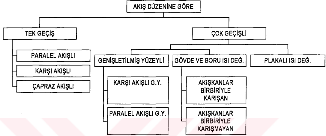
Şekil 2.6 Isı deęiřtiricilerin, akıř dzenine gre sınıflandırılması ( Tarakçı, 1991 )
