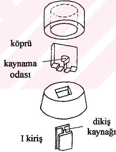
Şekil 2.20 Değiştirilebilir köprü ve kaynama odalarıyla, bir I kirişi için ekstrüzyon matrisi (Akaret, 1972).
