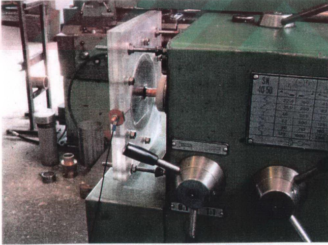
Resim 4.2 İş parçasına bağlı bakır milin fener mili arkasında kestamid ile yataklanması
