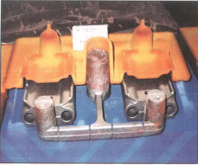
Şekil 5.26 Dökümden sonra oluşan çelik palet gövdesi
