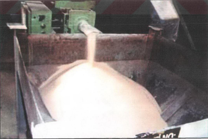
Şekil 5.7 Reçine kaplanmış kumun silodan alınarak kum sepetlerine doldurulması
