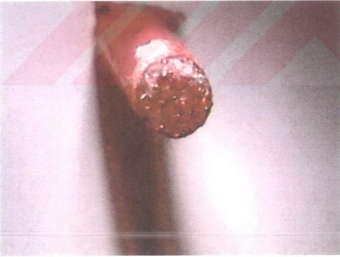
Şekil 9.5 2.Deneyden sonra elektrodun alttan görünüşü x10
