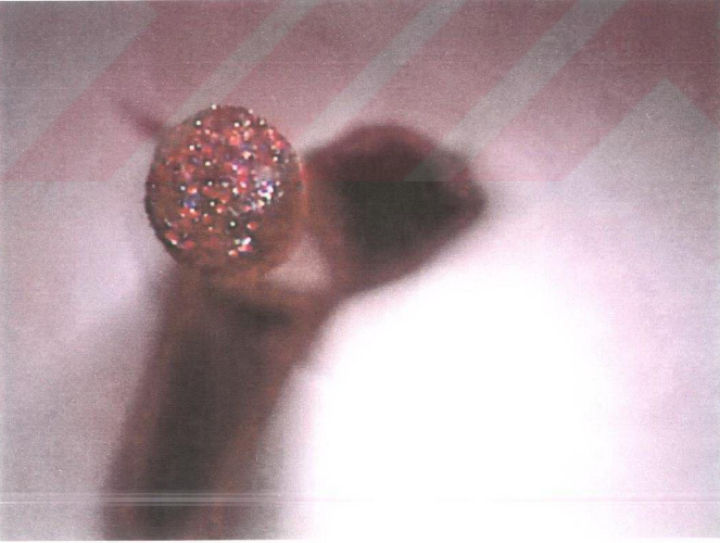
Şekil 9.2 1.Deneyden sonra elektrodun alttan görünüşü x10
